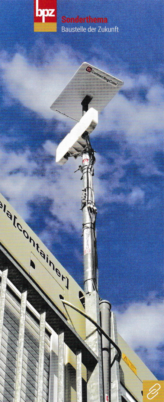
ConnectingCase bietet mit seinen Anlagen stabiles Internet für Baustellen und Projektgebiete und vereint dabei die Vorteile aus beiden Technologiewelten. Bild: ConnectingCase
