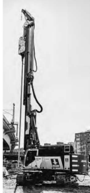
Die eRG 19 T hybrid der RTG Rammentechnik ist erstmals in Berlin im Einsatz.
